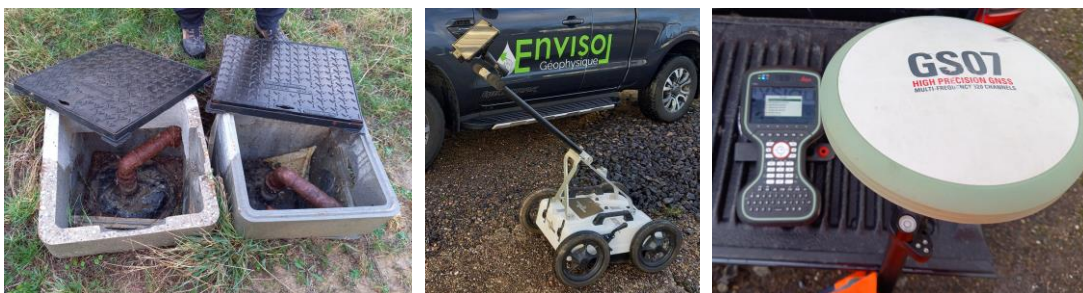
Figure 21. Observation des regards à gauche ; mise en place du géoradar au centre ; déploiement du GPS à droite.
